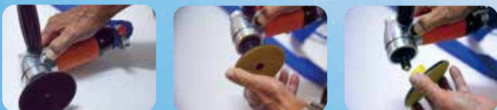
①ロックボタンを押し込み ②パッドを反時計回りに回転 ③スパナを使わず取り外し
